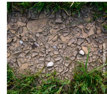
Bei einigen Böden können Veränderungen des Wasserhaushaltes zu einer lastunabhängigen Volumenveränderung des Korn- bzw. Mineralgefüges führen. Diese Vorgänge werden Schrumpfen und Quellen genannt; Wobei der Schwerpunkt im Folgenden auf den Schrumpfungsprozess gelegt werden soll.
